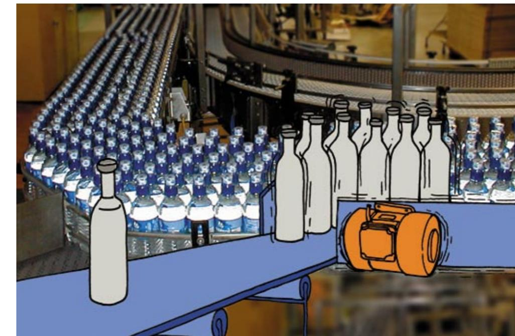
Вибраторы новой серии могут работать с преобразователем частоты, позволяющим регулировать частоту вибрации.
