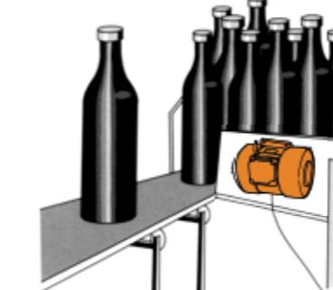
С преобразователем частоты возможна работа вибраторов на частоте более 3000 об./мин.
