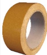
Лента на основе полипропиленовой фольги с плавким клеем и белой силиконизированной бумажной подкладкой. Лента рекомендуется для фиксации различных материалов, приклеивания легких напольных покрытий или для упаковки. Эта универсальная лента обладает превосходной адгезией к разным поверхностям: пластик, бумага, фольга, дерево, керамика и стекло. Ленту можно легко удалить вручную.
